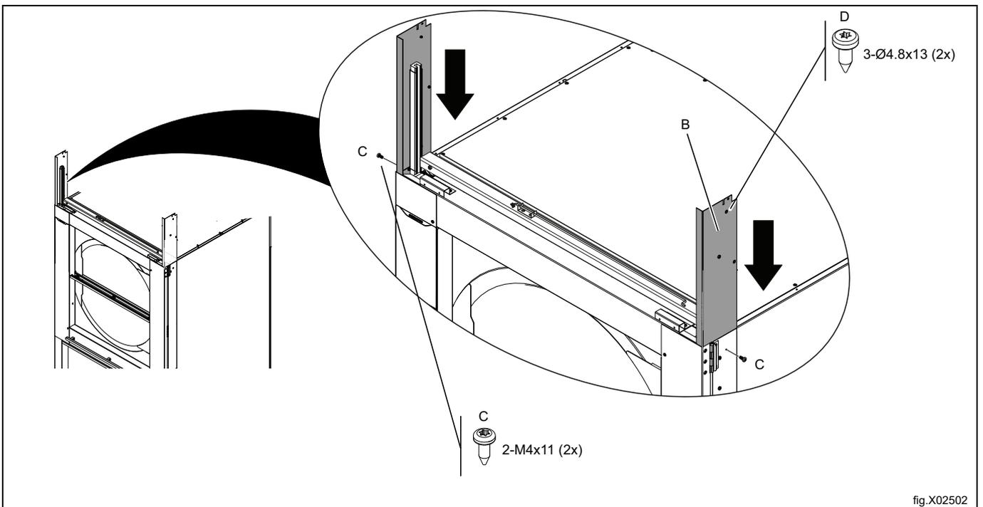
Monter les panneaux latéraux et les composants restants, comme décrit dans [Installation de l'unité de chauffage](#). Vérifier que les portes coulissent facilement.
