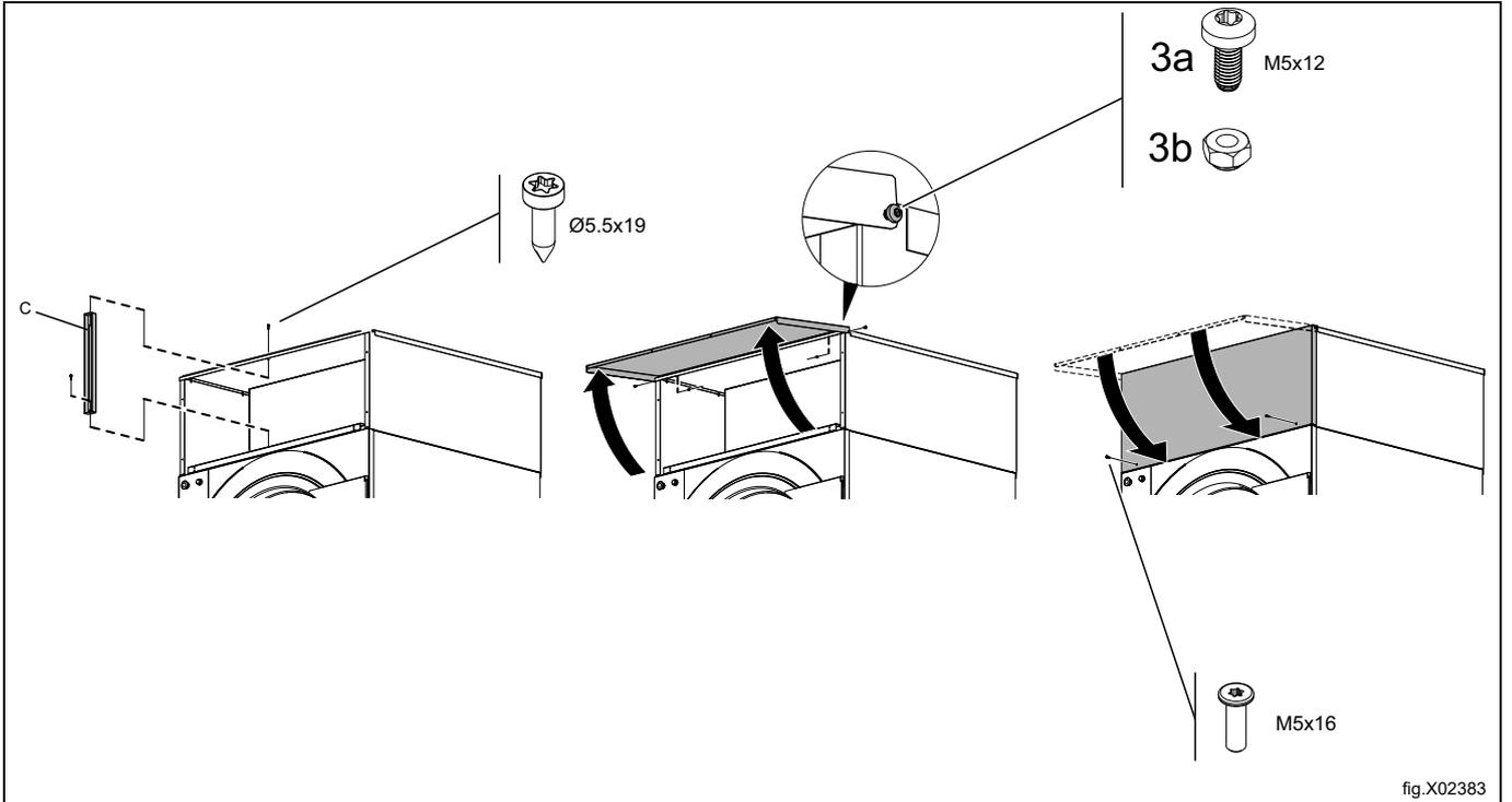
Mettre en place le panneau du sectionneur d'alimentation avec la poignée.
